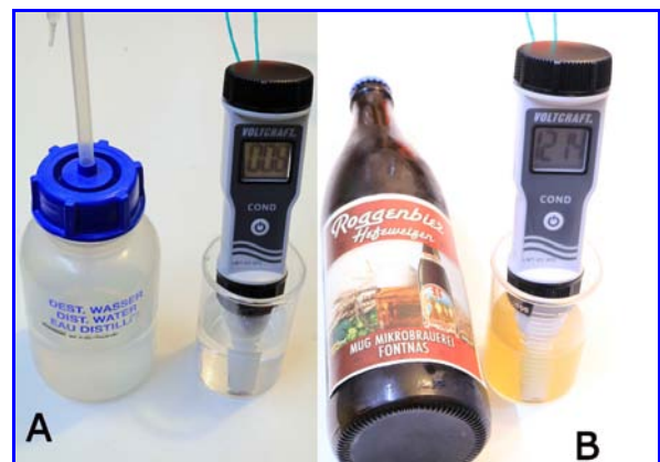
Abb. 7. Leitfähigkeitsmessungen in ention. Wasser und Hefe-Weizenbier.
