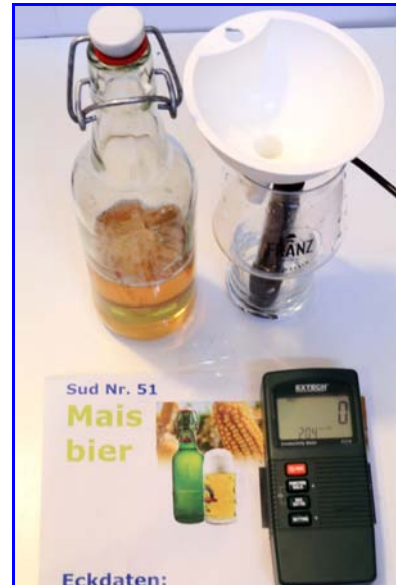
Abb. 6. Entgasung vor LF-Messung. CO 2 -haltige Lösungen sollten vor der LF-Messung entgast werden, da CO 2 -Gasblasen auf der Oberfläche der Polelektroden "kleben" und so die Messwerte verfälschen (cf. Tab. 2, CO 2 -begastes Wasser).
