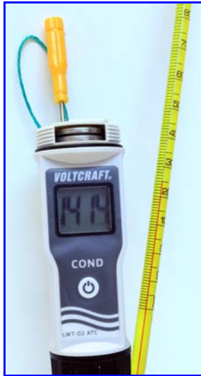
Abb. 3. Kalibrierung eines eLF-Messsticks. Bedingungen: frische 1'413 \mu\text{S}/\text{cm} Standardlösung, 25^\circ\text{C} ; Einstellung auf 1'413 \pm 1 \mu\text{S}/\text{cm} .
