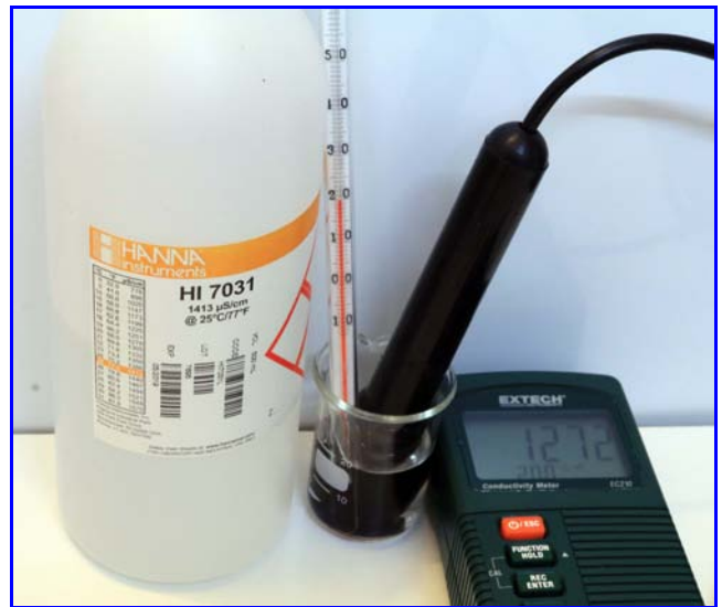
Abb. 5. Kalibrierung des LF-TDS-Gerätes bei 20^\circ\text{C} auf den Eichwert 1'278 \mu\text{S}/\text{cm} (cf. Abb. 4); eine Temperaturabweichung von nur 0.3^\circ\text{C} ( 19.7^\circ\text{C} ) ergibt bereits eine Abweichung von ca. 6 \mu\text{S}/\text{cm} .
