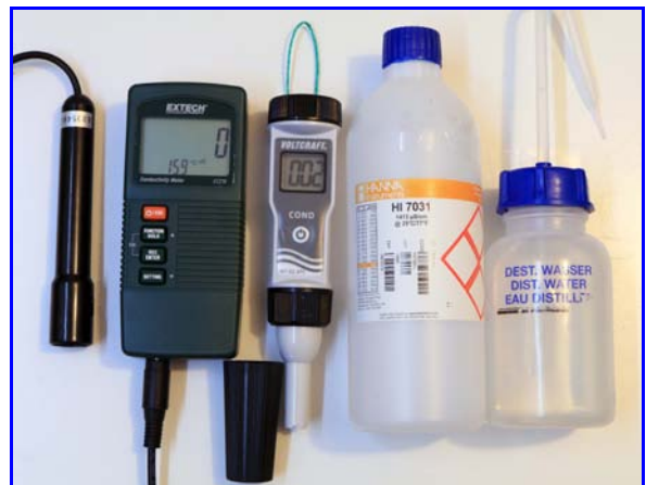
Abb. 2. Zwei Ausrüstungsniveaus zur Bestimmung der elektrischen Leitfähigkeit und des daraus erfassbaren TDS-Wertes.
