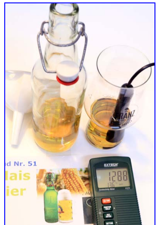
Abb. 8. TDS-Messung im entgasten Bier. Maisbier, TDS-Wert: 1'288 ppm.
