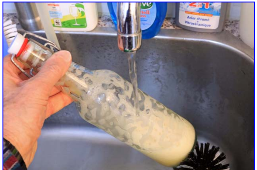
Abb. 10. Entgasen und Temperatureinstellung mit einer verschliessbaren Flasche. Die gashaltige Probelösung, z.B. Bier mit CO 2 wird geschüttelt und gleichzeitig unter dem warmen Wasser hin- und hergezogen. Mit einem Thermometer Temperatur messen und bei der Wunschtemperatur die TDS-/eLF-Messung in einem separaten Gefäss durchführen.
