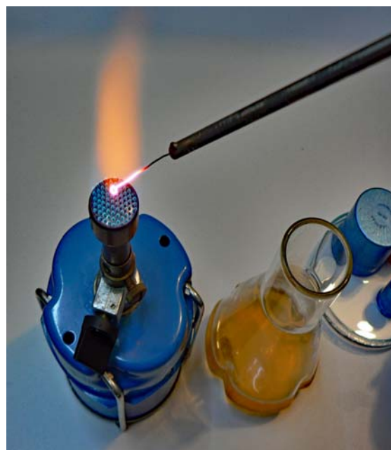
Abb. 2. Schlussphase des Ausglühens: die eigentliche Impföse muss weiss-orangerot glühen -> dann ca. 10 sec abkühlen lassen -> dann Impfoperation ausführen (z.B. Eintauchen in Hefesuspension im Erlenmeyerkolben).
