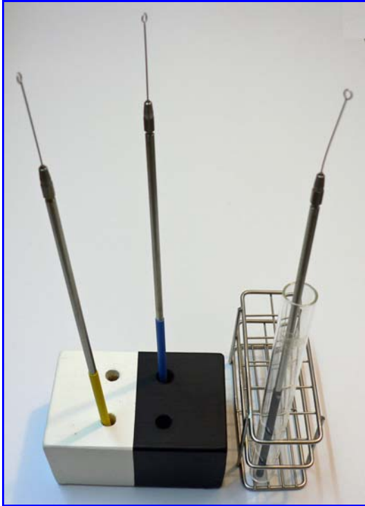
Abb. 3. Impfösen im Impfösenhalter. Links: ausgebohrter Holzblock mit 4 Löchern. Rechts: improvisierter Impfösenhalter aus Reagenzglasgestell mit Reagenzglas.
