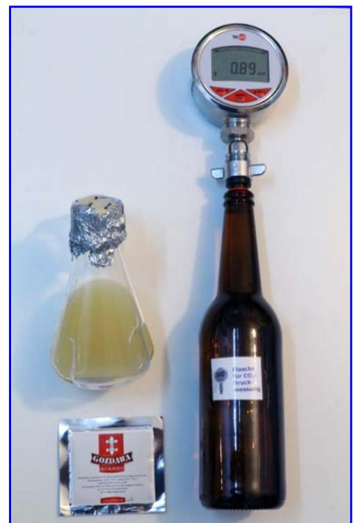
Abb. 2. Der CO<sub>2</sub>-Drucktest. Druckanzeige mit Digitalmanometer.
