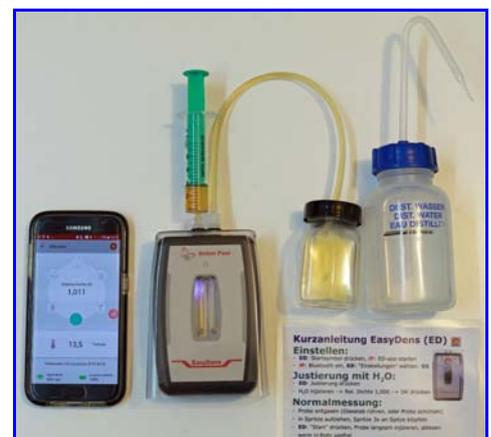
Abb. 5. EasyDens-Dichtemessgerät mit Smartphone, Injektionspritze, Auffangbehälter, ention. Wasser. Messanzeige auf SG (1.011 - Endpunkt der Hauptgärung).
