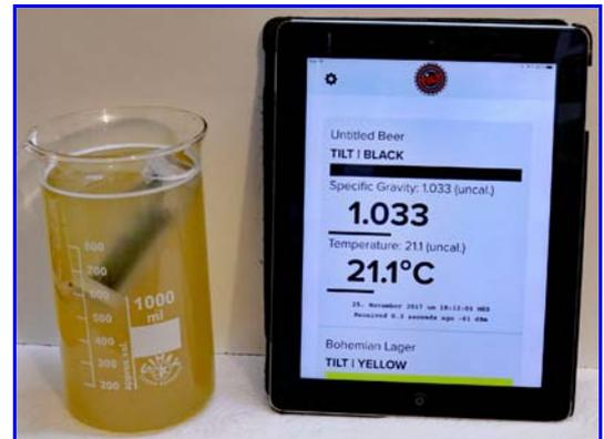
Abb. 4A. Extraktbestimmung mit dem TILT-Hydrometer während Testgärung in einem I-L-Ansatz.
