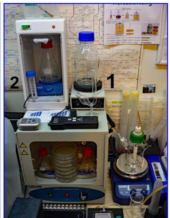
Abb. 3. Brutkammern und Magnetrührer sind ebenfalls unentbehrlich, sobald man Flüssigkulturen anziehen möchte (z.B. Anstellkultur). Es genügt aber auch eine einfache Ausrüstung: z.B. 1: nur Magnetrührer und Hefezuchtflasche; 2: etwas komfortabler: Mini-Brutschrank mit Magnetrührer.
